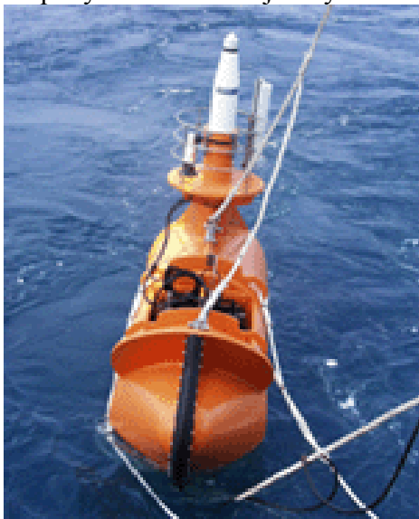
Figura 35: Boya de cola del streamer que emite una señal luminosa visible y otra de radar marcada por tres picos de alta intensidad, que permite determinar la posición exacta del barco y el streamer.
