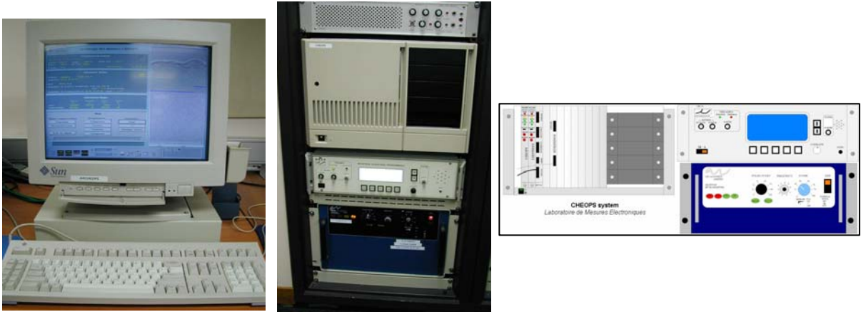
Figura 22: Sistema CHEOPS, mostrando el módulo de control (izquierda), la terminal (centro) y de la emisión/recepción de la señal (derecha).
