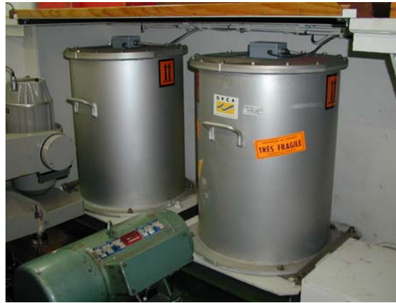
Figura 24: Sistema Hippy (RS232) para corregir el efecto del oleaje
