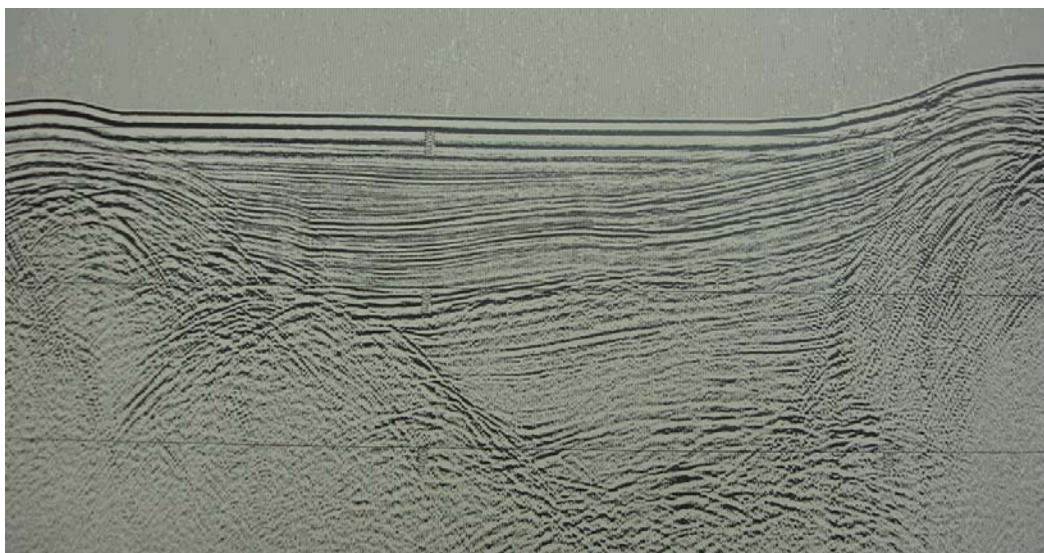
Figura 58: Ejemplo de un fragmento del registro de la línea 8 en la cuenca marginal, al pie del talud inferior. El registro fue obtenido mediante sísmica de alta penetración multicanal. Entre líneas horizontales el tiempo doble es de 1 s.
