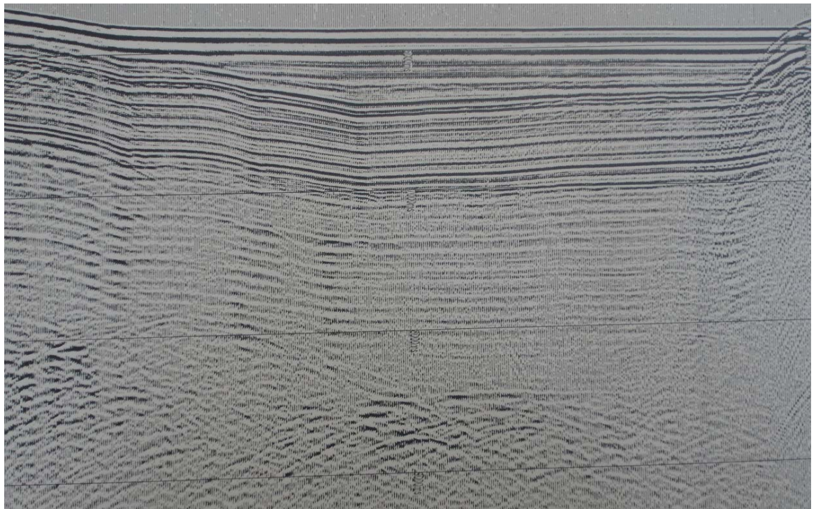
Figura 76: Ejemplo de un fragmento del registro de la línea 15. Se puede observar la relación existente entre las diferentes unidades sismoestratigráficas El registro fue obtenido mediante sísmica de alta penetración multicanal. Entre líneas horizontales el tiempo doble es de 1 s.
