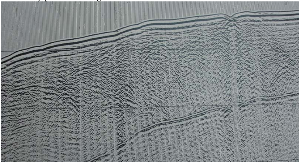
Figura 40: Ejemplo de un fragmento del registro de la línea 1 en la zona de arcos tectónicos. El registro fue obtenido mediante sísmica de alta penetración multicanal. Entre líneas horizontales el tiempo doble es de 1 s.
