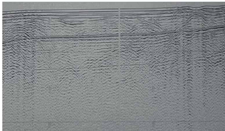
Figura 83: Ejemplo de un fragmento del registro de la línea 22, donde se observan estructuras diápiricas. El registro fue obtenido mediante sísmica de alta penetración multicanal. Entre líneas horizontales el tiempo doble es de 1 s.
