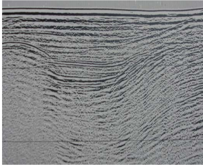
Figura 41: Ejemplo de un fragmento del registro de la línea 1 en la zona de la Cuenca Rharb. El registro fue obtenido mediante sísmica de alta penetración multicanal. Entre líneas horizontales el tiempo doble es de 1 s.
